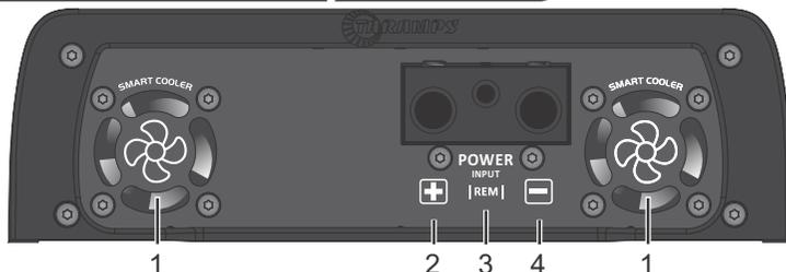
**1 - SMART COOLER:** Este amplificador possui dois coolers de ventilação interna. Para perfeito funcionamento, o amplificador deve ser instalado em local seco e arejado, com espaço livre de no mínimo 1" (25mm) de cada lado. A temperatura normal de trabalho deste amplificador é de 65°C.
