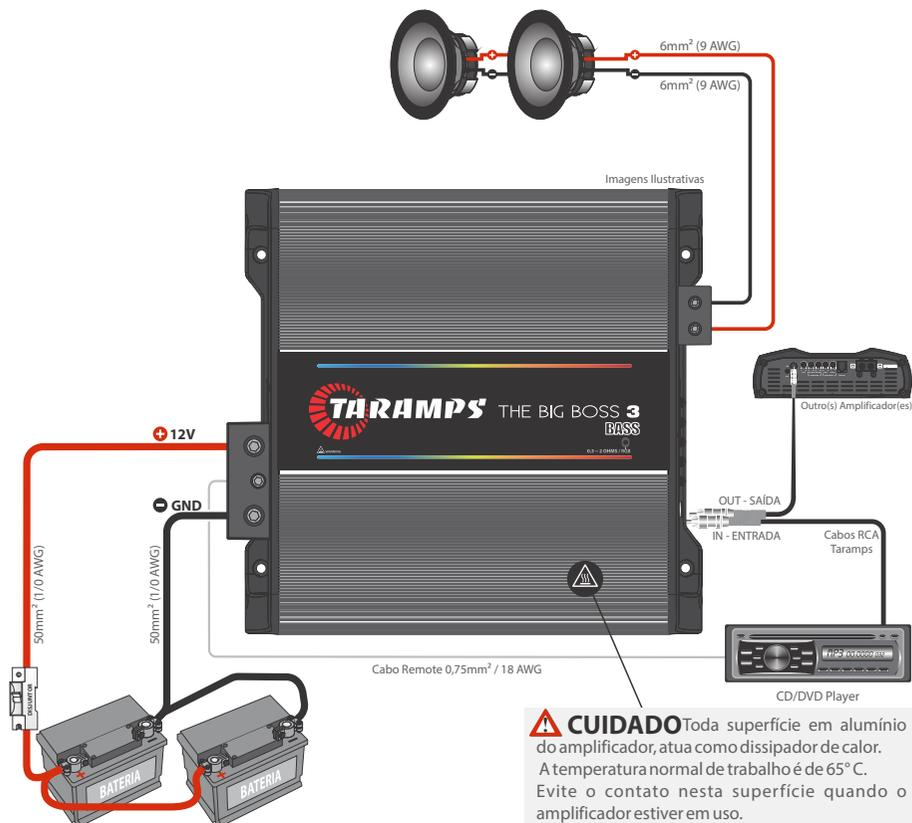
**⚠ CUIDADO** Toda superfície em alumínio do amplificador, atua como dissipador de calor. A temperatura normal de trabalho é de 65° C. Evite o contato nesta superfície quando o amplificador estiver em uso.
